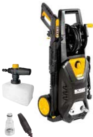
HIDROLIMPIADORA 145253 Caudal 480 L/h. Presión 160 BAR. Potencia 2.200 W.
