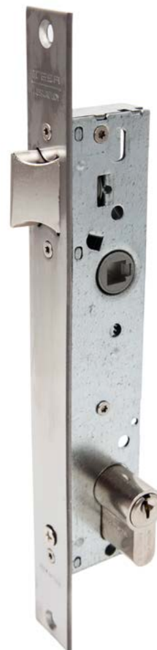
CERRADURA METÁLICA 7572 2219203AI. Para carpintería metálica. Picaporte reversible accionado por manilla. Cilindro de 60 mm. No incluye cerradero. Frente inox. 20 mm. 44'95
