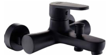
GRIFO BAÑO MONOMANDO 130571 18x19,85x12,37 cm. Conexión para flexo 1/2". Aireador M24. Incluye mango y soporte de ducha y flexo de metal. 72'95
